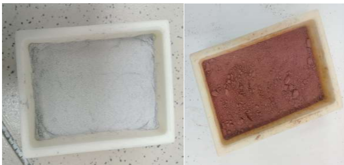
Рисунок 30 – Исходная шихта: \text{TiO}_2/\text{FeO}/\text{Nb}_2\text{O}_5 (слева) и \text{TiO}_2/\text{Fe}_2\text{O}_3/\text{Nb}_2\text{O}_5 (справа)
